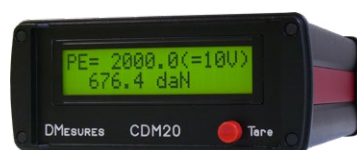
Conditionneur/afficheur de laboratoire, sortie analogique en tension
